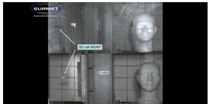
Gambar 11. Proyektil peluru mulai melesat menuju masing-masing objek, yaitu glass laminate (atas) dan ALON (bawah) [10]
