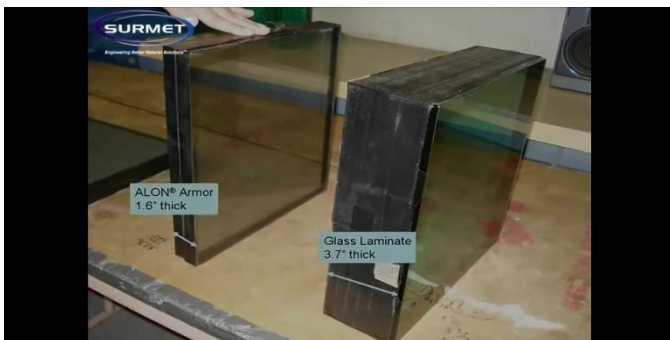
Gambar 9. Perbandingan ketebalan ALON dan glass laminate yang digunakan pada pengujian [10]
