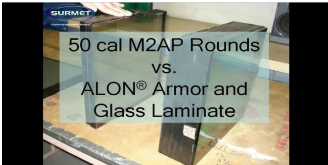
Gambar 8. Pengujian ALON dan glass laminate terhadap peluru 50 cal M2AP ( Armor Piercing ) [10]
