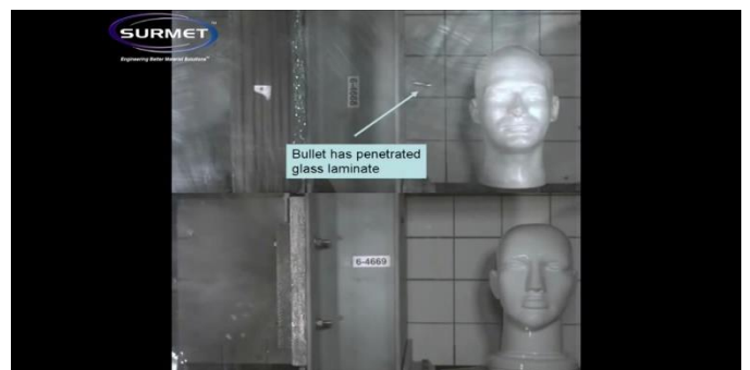
Gambar 13. Proyektil peluru berhasil menembus glass laminate (atas), namun tidak berhasil menembus ALON (bawah) [10]
