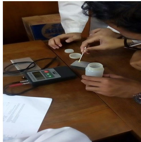
Gambar 12. Pengolesan couplant Pada UTG
