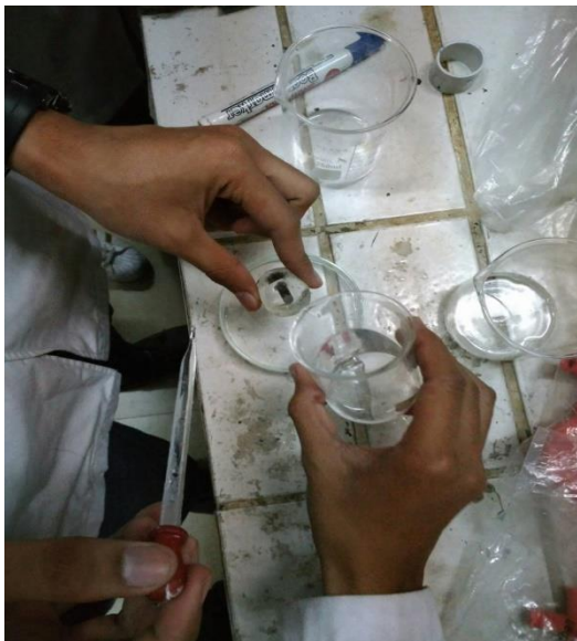
Gambar 8. Pembilasan spesimen dengan Etanol setelah pemberian nital
