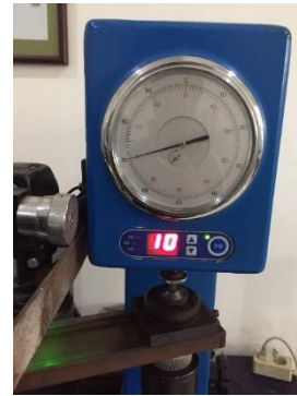
Gambar 2.4 Pengujian kekerasan dengan menggunakan indentor Brinell dengan lama waktu indentasi 10 detik.
