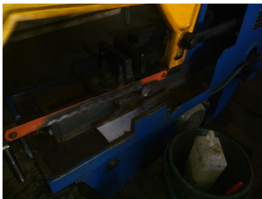
Gambar 2.1 Proses pemotongan spesimen
