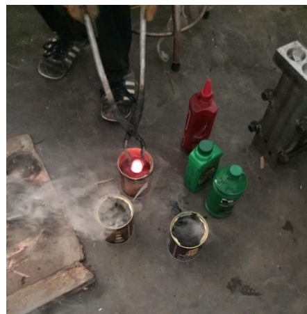
Gambar 2.3 Proses Quenching menggunakan 3 jenis oli yaitu SAE 20, SAE 40 dan SAE 90.
