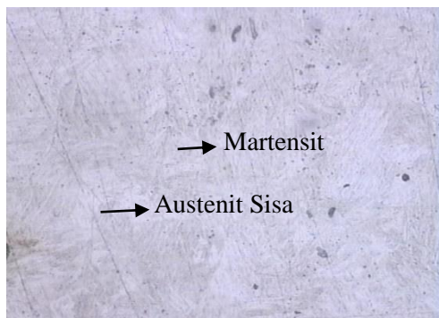
Gambar 3.3 Strukturmikro Baja AISI 4340 Quenching SAE 20 dengan perbesaran 500x
